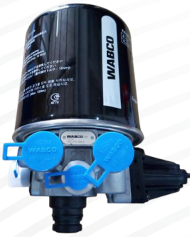
أنظمة التحكم في الإنذار Air Dryer Assy
